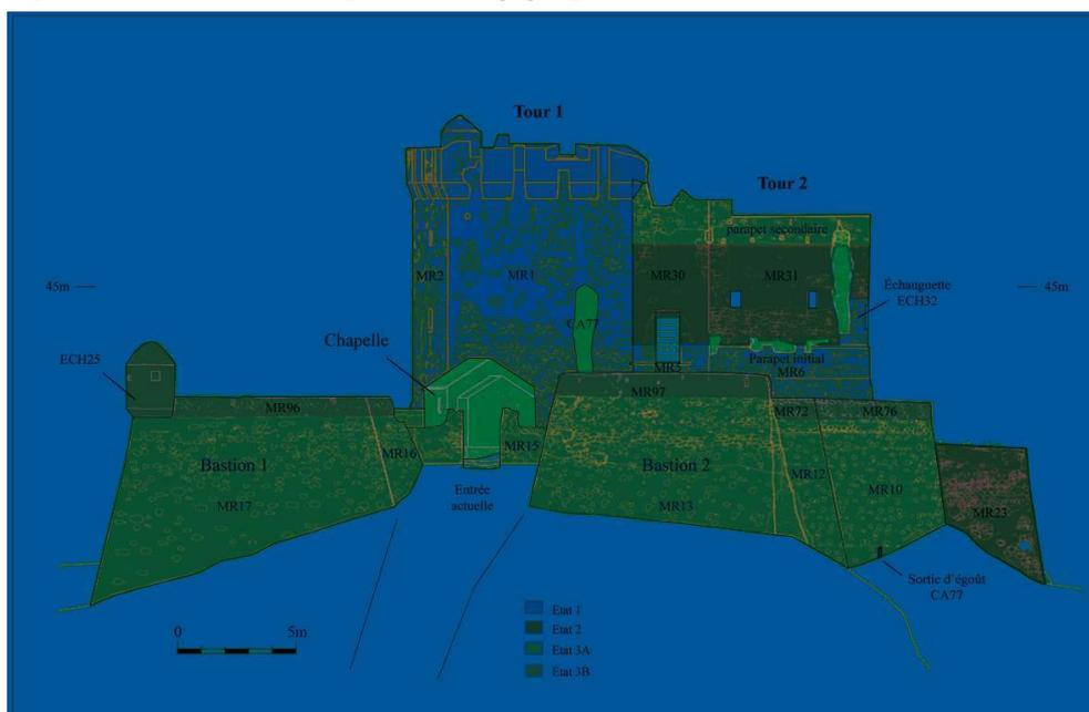
**Fig. 1****FACE NORD DU BASTION AVEC LES DEUX FORTINS. PHASAGE DE LA CONSTRUCTION.**
