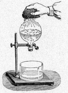
FIG. 140. — BOUILLEUR DE FRANKLIN. En versant de l'eau froide sur un ballon vide d'air et renfermant de l'eau chaude, on provoque une condensation partielle de la vapeur et, par suite, l'ébullition de l'eau chaude.
