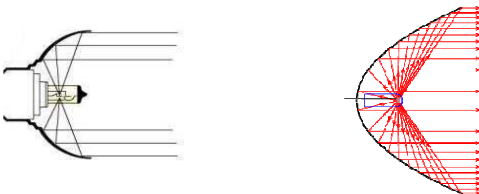
Figure 1 : Miroir (ou réflecteur) parabolique
