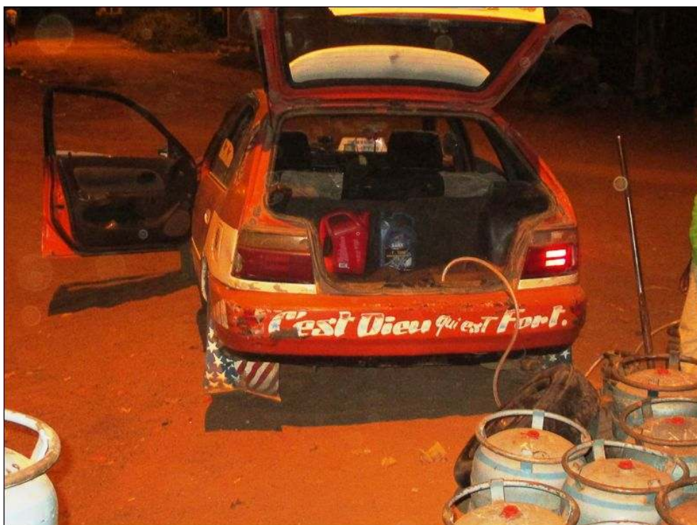
Illustration 9 - Remplissage de la bombonne d'un taxi de gaz butane en lieu et place du carburant
