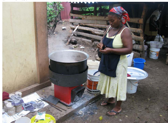
Figure 3. Foyer collectif écoénergétique qui consomme des briquettes de biomasse fabriquées localement en Haïti © Prakti
