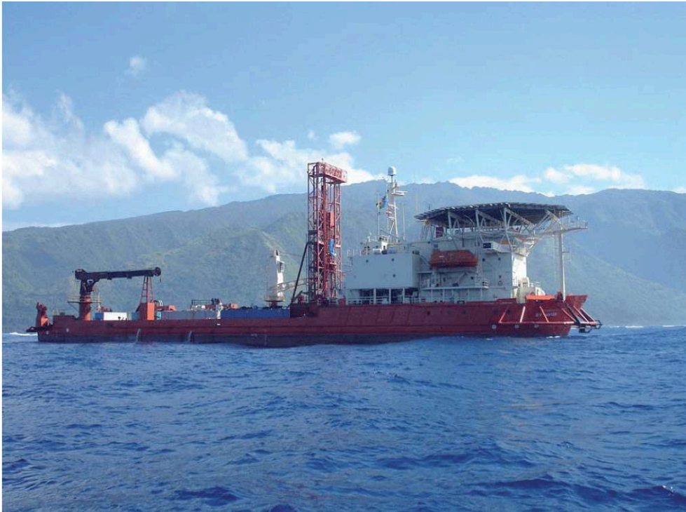
« DP Hunter », bateau de forage armé par ESO (ECORD Science Operator : http://www.eso.ecord.org/ ) afin de carotter au large de l'île de Tahiti le récif corallien (© ESO).
