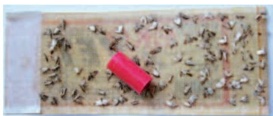
Piège à phéromone, constitué d'une plaque de glu et d'une capsule de phéromone (en rouge) utilisé ici pour le piégeage des mites alimentaires Plodia interpunctella .
