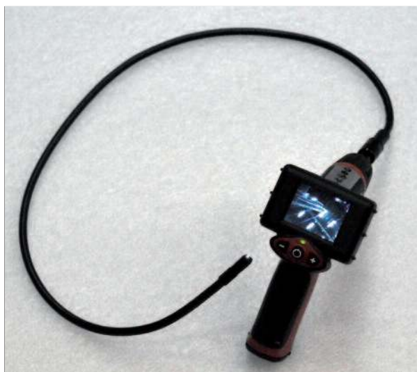
L'endoscope, appareil utilisé pour visualiser les endroits peu accessibles à la recherche de trace d'activité d'insectes.
