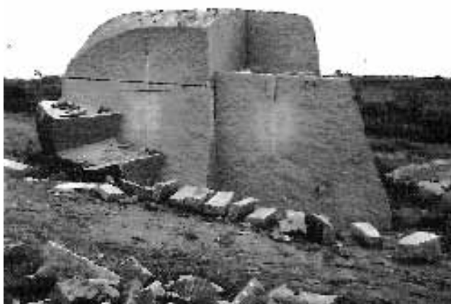
Photo III : Près du Huelgoat, en 1956 : à l'issue du dépeçage de l'énorme boule granitique, les vestiges de l'exploitation auront disparu sans guère laisser de traces (noter les traces d'explosion dans les trous de perforation – cf. § 5).
