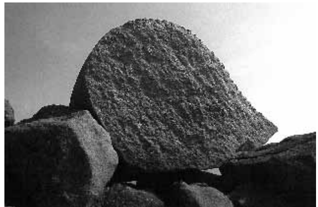
Photo XIII : À Penn-ar-Warenn, sur l'île Callot en baie de Morlaix, fente parfaite d'une boule de granite rose par la méthode des coins.
