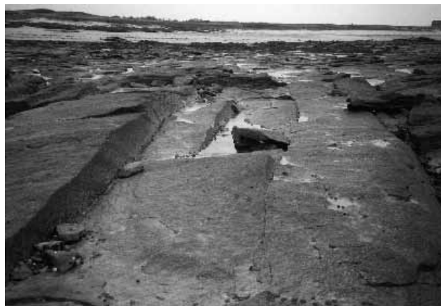
Photo IV : Au sud-ouest du port de La Croix (île Hoedic, Morbihan), l'extraction du granite a été facilitée par la structure en dalles épaisses peu inclinées. L'estran actuel est parsemé de mares artificielles.
