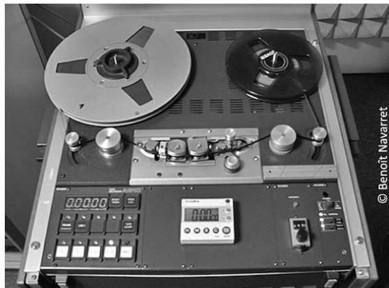
**Figure 2 :** Magnétophone Studer A810 utilisé au sein de l'équipe LAM afin de tester la vraisemblance d'un pré-écho de trois secondes par effet de copie.
